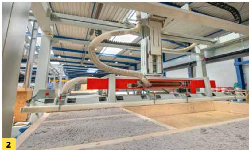
*Das nahezu doppelt hohe Füllgewicht im Vergleich zur Stein- und Mineralwolle sorgt für eine hochdichte, formstabile Dämmung der einzelnen Gefache und erhöht damit den Schallschutz, bei gleichbleibender Wärmeabschirmung.*
