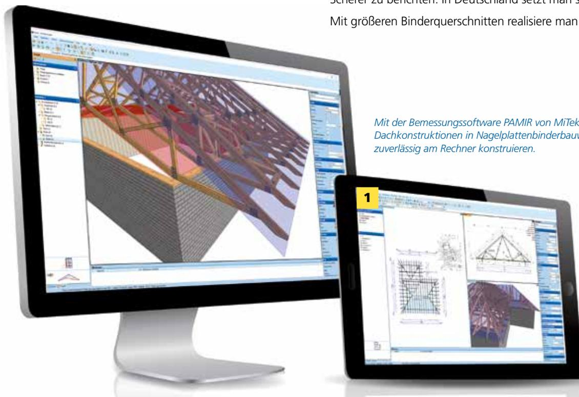
*Mit der Bemessungssoftware PAMIR von MiTek lassen sich Dachkonstruktionen in Nagelplattenbinderbauweise schnell und zuverlässig am Rechner konstruieren.*
