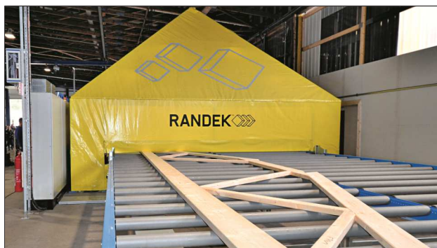
Presszelt der „Autoeye“-Anlage von Randek: Die Anlage kann pro Tag mehrere hundert Nagelplattenbinder produzieren. Die ins Holz gepressten Nagelplatten liefert Mitek Industries. Fotos: A. Zielke (4)
