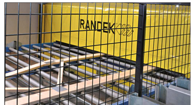
Presszelt der „Autoeye“-Anlage von Randek: Die Anlage kann pro Tag mehrere hundert Nagelplattenbinder produzieren. Die ins Holz gepressten Nagelplatten liefert Mitek Industries. Fotos: A. Zielke (4)
