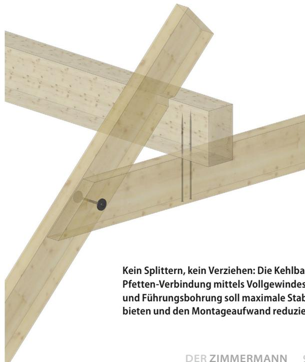
**Kein Splittern, kein Verziehen: Die Kehlbalken-Pfetten-Verbindung mittels Vollgewindeschraube und Führungsbohrung soll maximale Stabilität bieten und den Montageaufwand reduzieren.**
