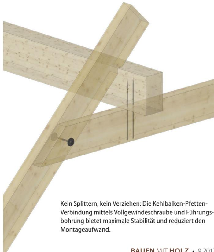
Kein Splittern, kein Verziehen: Die Kehlbalken-Pfetten-Verbindung mittels Vollgewindeschraube und Führungsbohrung bietet maximale Stabilität und reduziert den Montageaufwand.
