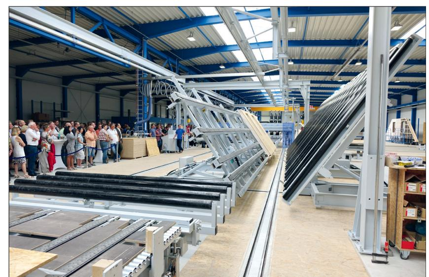
Bei der Fertigung von beidseitig geschlossenen Elementen kommt dem Schmetterlingswender eine zentrale Bedeutung zu.
