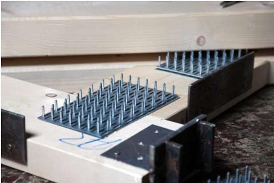
Flächenpressen verbinden die Knotenpunkte mit den Nagelplatten.
